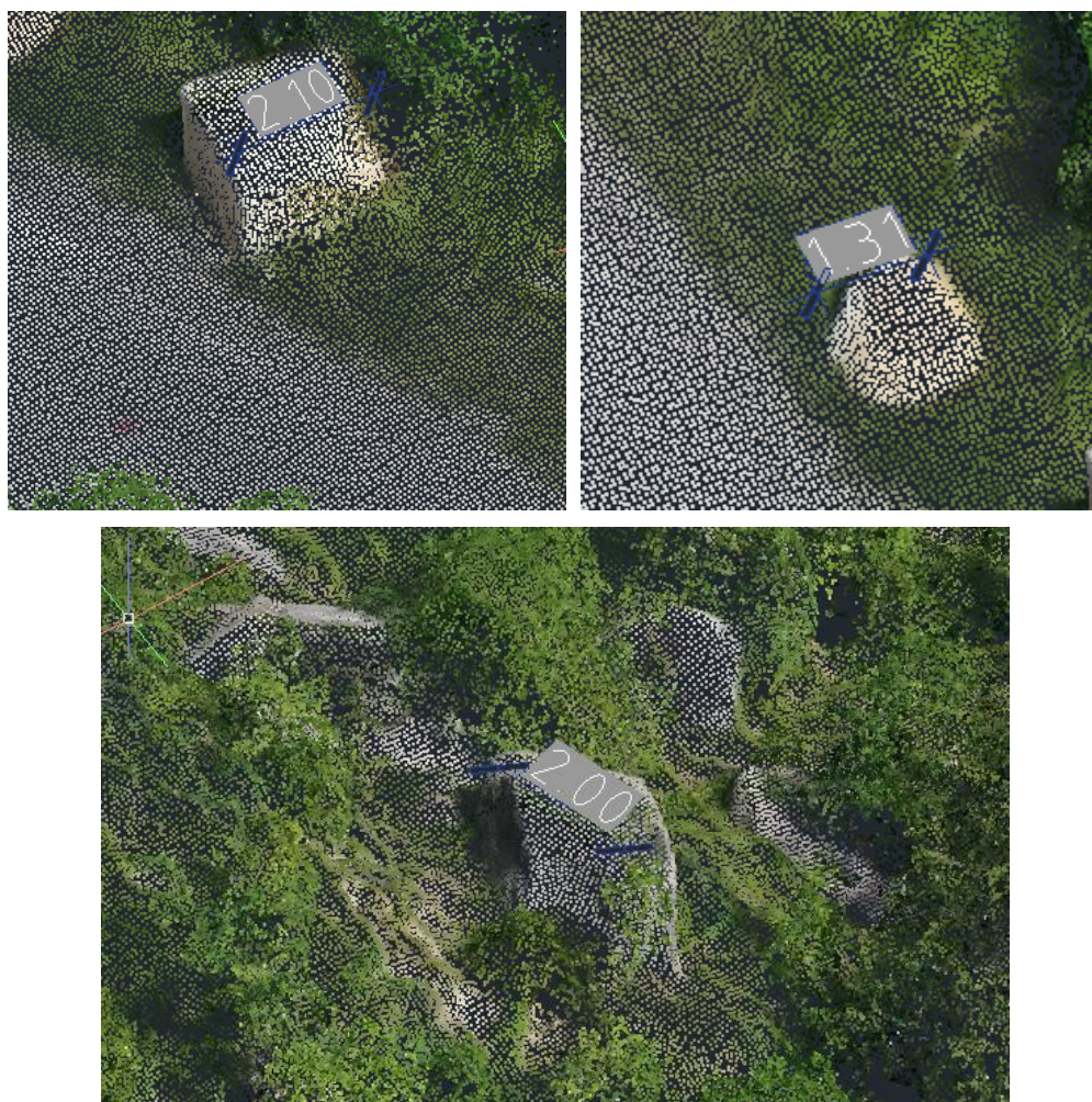
Slika 11: Dimenzije kamenja akumuliranega ob cesti in na trajektoriji KPP 1
