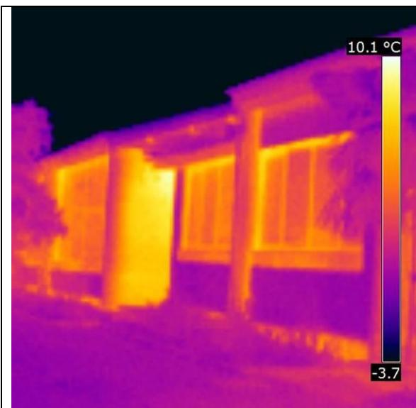
Po celotnem objektu se na stikih prečnih betonskih sten s fasado pojavljajo toplotni mostovi.
